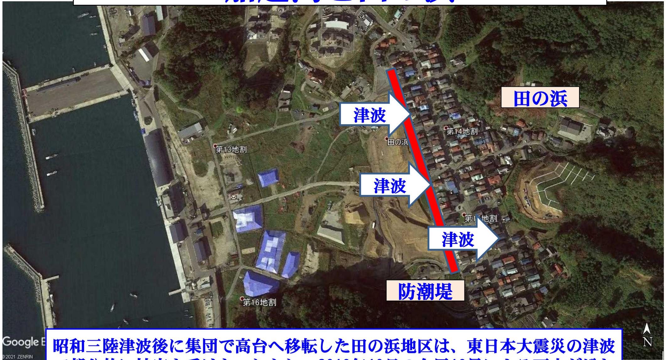
昭和三陸津波後に集団で高台へ移転した田の浜地区は、東日本大震災の津波で部分的に被害を受けた。しかし、2019年10月の台風19号による雨水が溢れたが、3.5m高の堤防が妨げとなって排水できず全面的に冠水
