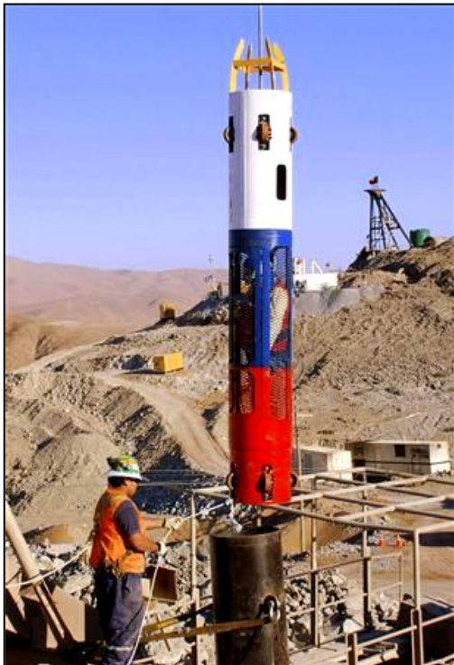
地下に閉じ込められた作業員に物資を補給するための細いチューブ（2本のうちの1本）
